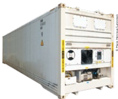
Contêiner reefer – refrigerado.
